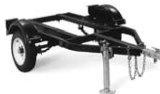
**Remolque HWY-1000 #195 013** Un remolque de carretera de capacidad de 1000 lbs. (454 kg) con marco de tubería de acero soldada, con eje de servicio pesado, con cubos de cojinetes de rodillo y suspensión de resortes de hoja. El HWY-1000 viene con gato de enganche, enganche de bola de 2 pulg. (50 mm), guardabarros y luces.
